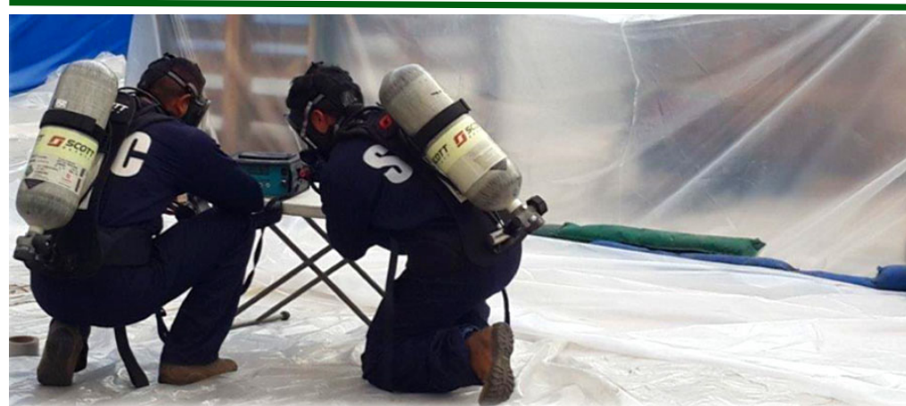
Auxiliares del SITC realizan una medición de concentración de Bromuro de Metilo durante el curso realizado en San Marcos, Guatemala.
